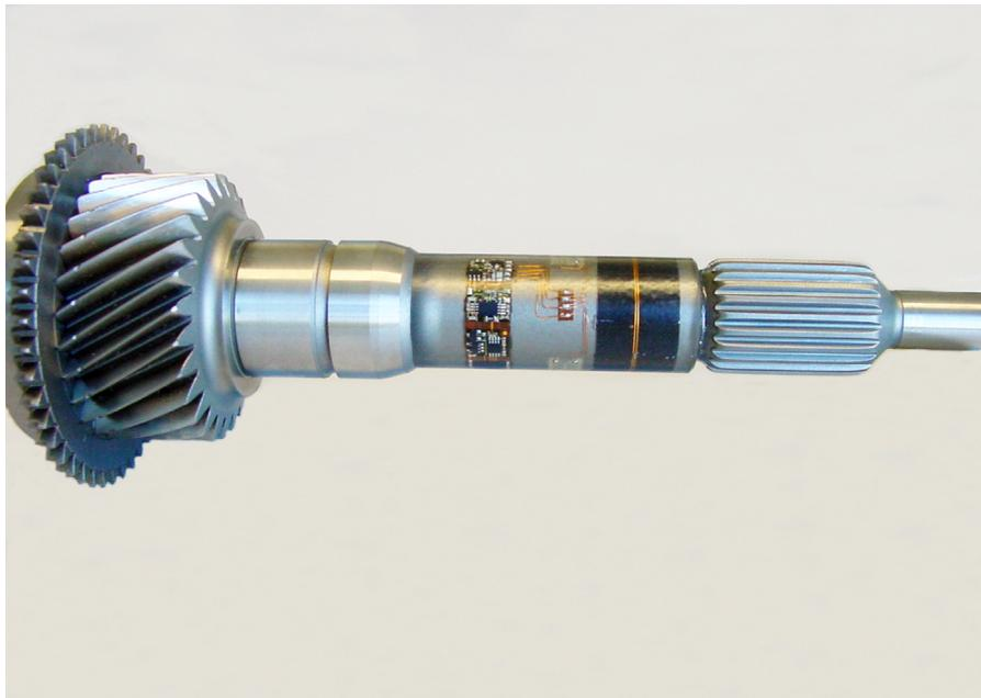
***Amplificateur de télémessure flexible***
